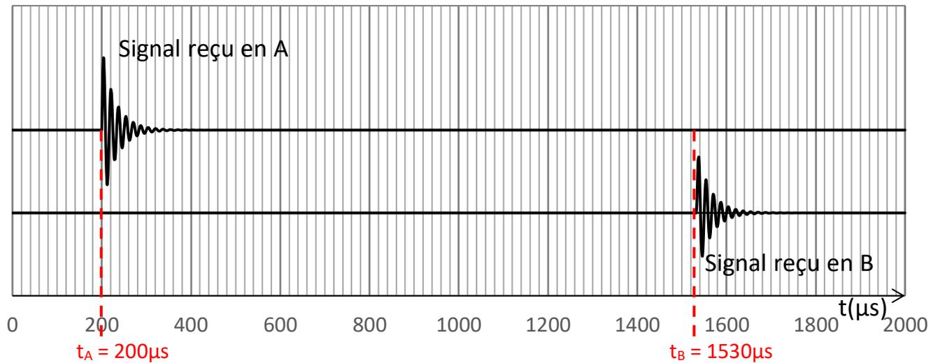
On relève la date à laquelle le récepteur A reçoit le signal sonore :  $t_A = 200 \mu\text{s}$
